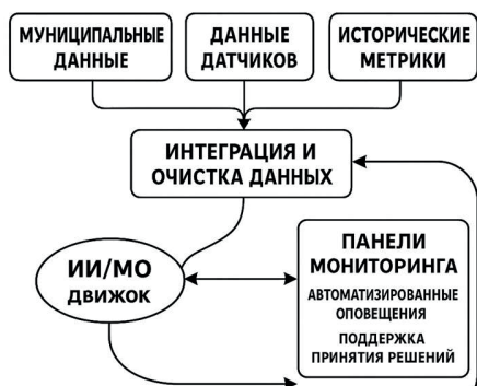
Рис. 1. Концептуальная модель интегрированной платформы предиктивной аналитики
